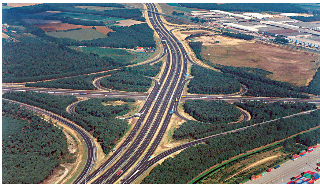
Figura 3.25. Ejemplos de distinto tratamiento de los hábitats que quedan aislados por enlaces y rotondas, con un resultado de elevada alteración de los mismos en uno de los casos (arriba). Fuente: Ortofotomapa 1.25.000, Institut Cartogràfic de Catalunya i Foto de Rijkswaterstaat (en Iuell et al. 2005).
