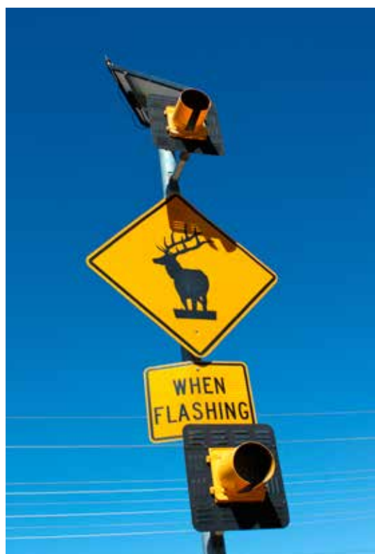
Figura 17.3. Señal de advertencia de peligro que emite destellos luminosos y que se activa mediante sensores de detección de fauna (ADS). Foto: C. Rosell.
