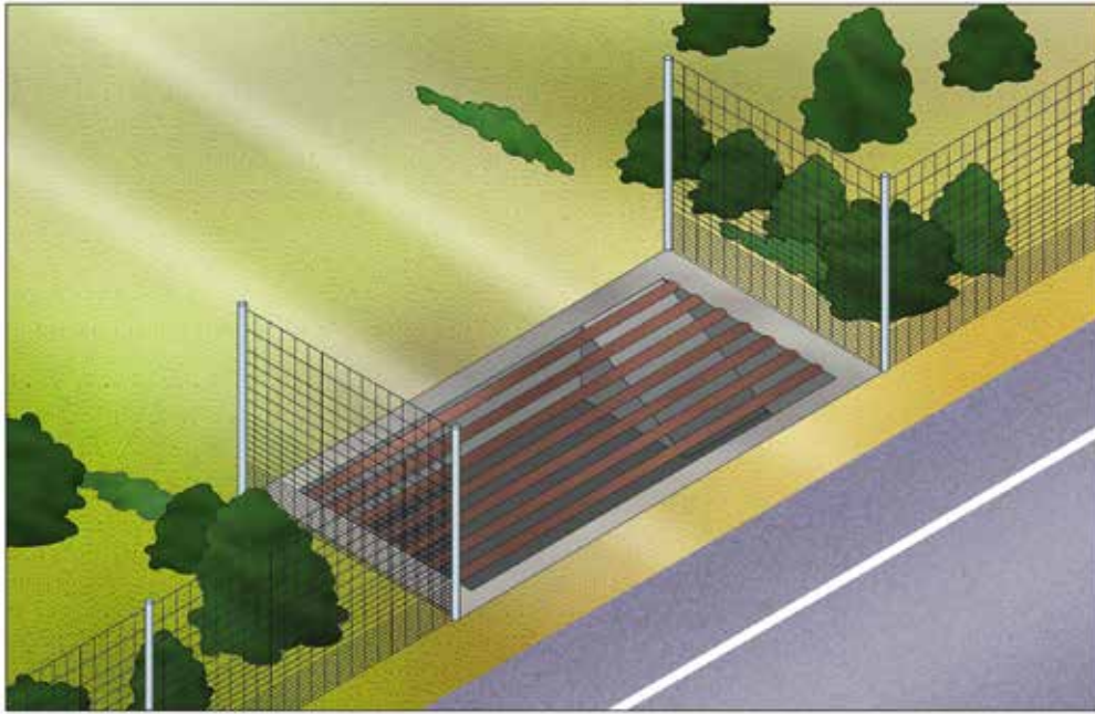
Figura 15.6 Esquema general de un paso canadiense que impiden el paso de ungulados, y al cual se ha añadido una rampa para facilitar la salida de animales que pudieran caer accidentalmente en su interior.
